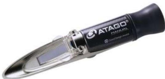
Ручной оптический рефрактометр для определения концентрации веществ в растворе по шкале растворенной в воде сахарозы % Brix. Внимание! Рефрактометр не имеет функцию автоматической температурной компенсации (АТС). Внимание! Прибор не имеет уровень защиты от пыли и воды IP65, мыть под струей воды противопоказано. Калибровка рефрактометра производится чистой водой или рефрактометрической жидкостью "Сахарозка".
