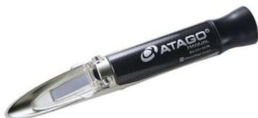
Ручной оптический рефрактометр для определения концентрации веществ в растворе по шкале растворенной в воде сахарозы % Brix. Внимание! Рефрактометр не имеет функцию автоматической температурной компенсации (АТС). Внимание! Прибор не имеет уровень защиты от пыли и воды IP65, мыть под струей воды противопоказанно. Калибровка рефрактометра производится чистой водой или рефрактометрической жидкостью "Сахарозка".
