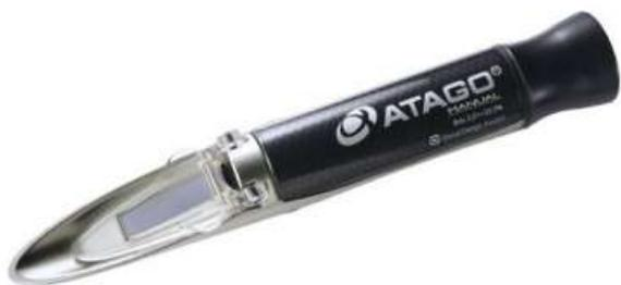
Ручной оптический рефрактометр для определения концентрации веществ в растворе по шкале растворенной в воде сахарозы % Brix. Внимание! Рефрактометр не имеет функцию автоматической температурной компенсации (АТС). Внимание! Прибор не имеет уровень защиты от пыли и воды IP65, мыть под струей воды противопоказанно. Калибровка рефрактометра производится рефрактометрической жидкостью "Сахарозка".
