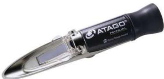
Ручной оптический рефрактометр для определения концентрации веществ в растворе по шкале растворенной в воде сахарозы % Brix. Внимание! Рефрактометр не имеет функцию автоматической температурной компенсацией (АТС). Внимание! Прибор не имеет уровень защиты от пыли и воды IP65, мыть под струей воды противопоказанно. Калибровка рефрактометра производится рефрактометрической жидкостью "Сахарозка".
